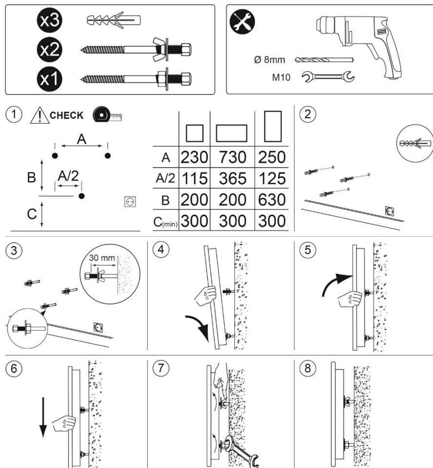
**⚠** Před vrtáním zkontrolujte rozměry a vyrovnání. Rozměry v mm
