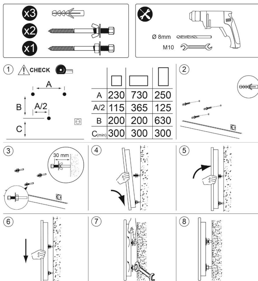
**⚠** Provjerite mjere i niveliiranost prije bušenja. Mjere u mm
