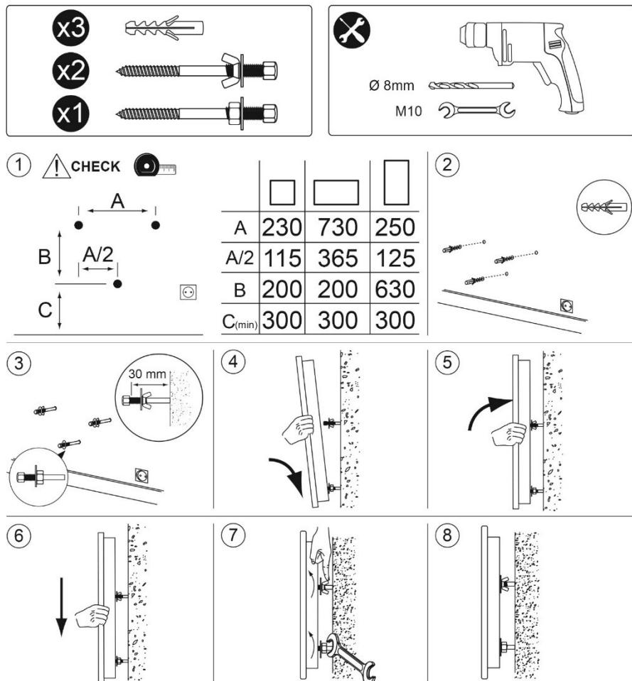
⚠ Проверете разстоянията и нивелацията, преди да пробиете отвори. Разстоянията са в мм
