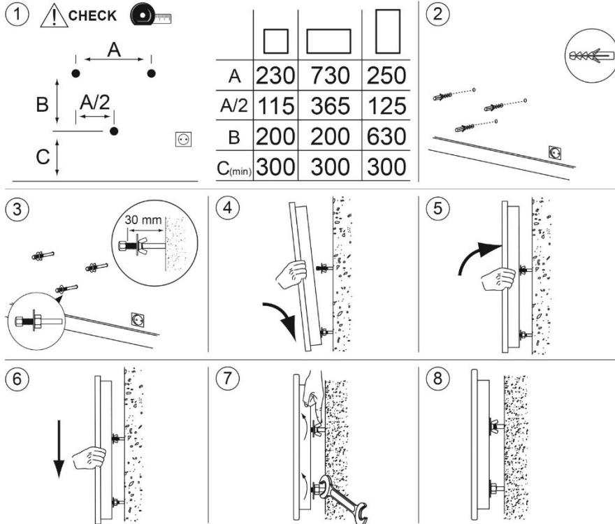
**⚠** Überprüfen Sie die Maßnahmen und Nivellierung vor dem Bohren. Maße in mm.
